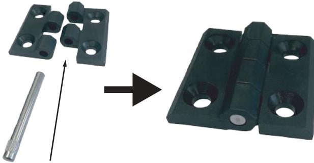
Pour fixer les socles sur votre Hanoucar il faut insérer la tige en métal (coté dentelé en fin de course) dans les encoches alignées des fixations à l'aide d'un marteau.
