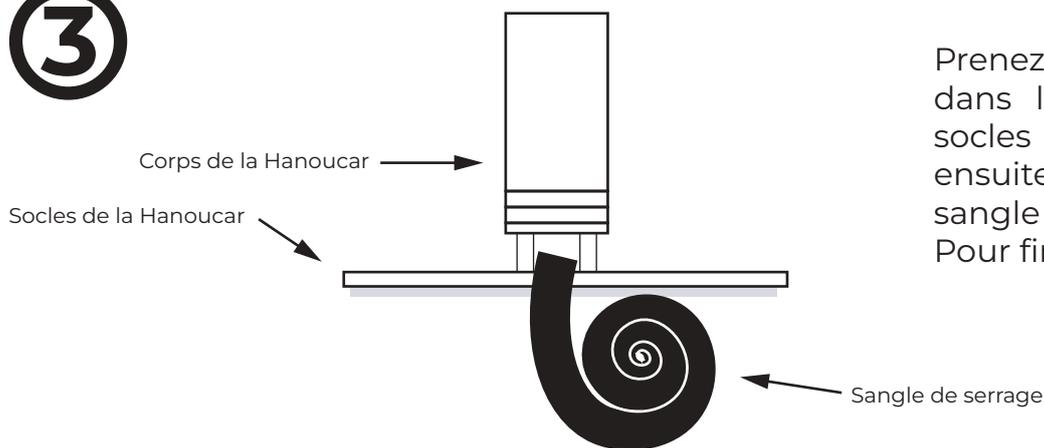
Prenez la sangle et faites-la passer dans l'encoche prévue sur les 2 socles de la Hanoucar. Ramenez ensuite les 2 extrémités de la sangle à l'intérieur de la voiture. Pour finir, serrez la sangle.
